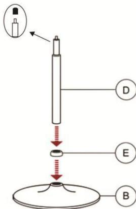
2. Coloque a coluna em aço na base.
