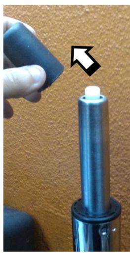
**Cilindro sem a tampa protetora, pronto para montagem.**
